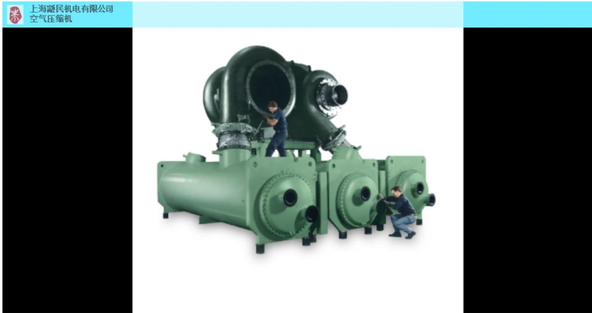
离心式空压机缺点有：①压力上升与气体比重和回转体速度有关，每级压力上升比容积式低，流量小情况下其效率也会降低。②压缩特性对设计，机械加工度，使用条件敏感。③压力-排量特性包含不安定因数，运转时使用风量降至预计70~80%时，出现震动现象。。以膜片运动方式分为机械运转和油压运转。机械式膜片空压机为小型空压机。机械式价格比较低，机构简单，压缩压力低于大气压力。机械式需要考虑到轴承重量，受到使用限制。但油压式比机械式容易产生高压。膜片式空压机优点如下：①密封性能强，可以到稳定压力。②与气体完全分开压缩，可以到\*\*无油清洁压缩空气。这种形式缺点是排出量低，压缩比受到限制。机械式采用合成膜片。油压式采用金属膜片，可以形成高压。这两种可以合成为两级压缩。机械式膜片空压机形成高压，采用压力容器把箱体和空压机密封形式。，回转体上又设置了叶片。叶片与汽缸空间回转体旋转变压缩空气。通常使用润滑油注入到汽缸内产生密封，润滑，同时解决发热油冷却形式。这种形式叶片与汽缸或旋转体产生磨擦，对叶片材质非常重要，应选择耐热性能高，对油或水分吸收率小材料。但有如下缺点。①从结构上不可避免因旋转而产生磨擦。
